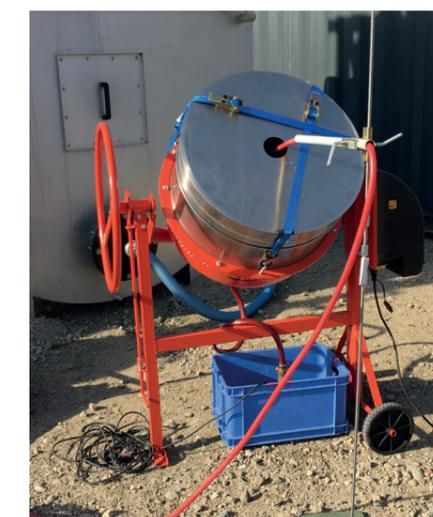
Bild 2 Beispiel für Probenahmeapparatur: Rotierender Siebfilter („RoSi“) der TU Berlin mit 10 µm Tressengewebe
